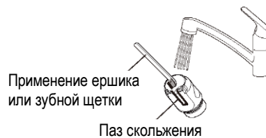
Рис. 5-5 Очистка отверстия и детали скольжения
