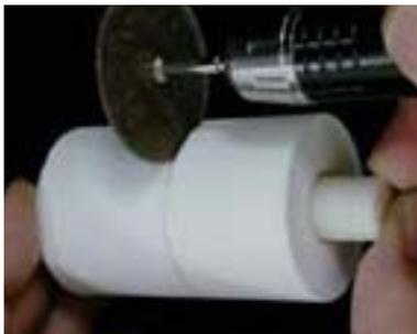
Разрезание с помощью сепарационного диска
