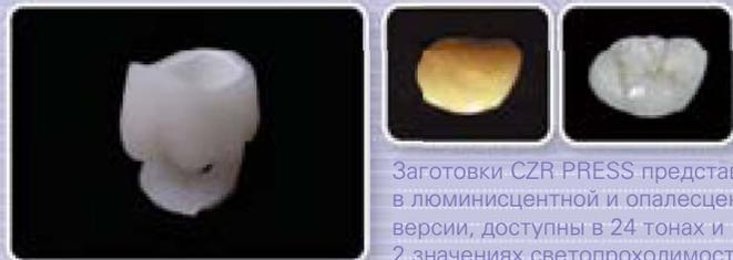
Заготовки CZR PRESS представлены в люминисцентной и опалесцентной версии, доступны в 24 тонах и 2 значениях светопроходимости.
