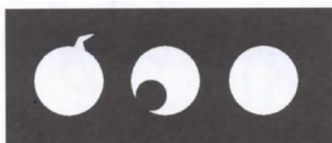
Разрыв Не полное отверстие Правильно отверстие
