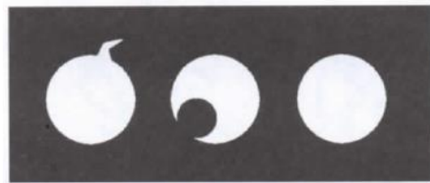
Разрыв Не полное отверстие Правильно
