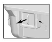
• Надавите на фиксирующий выступ и извлеките электронный защитный ключ-заглушку CAN.
